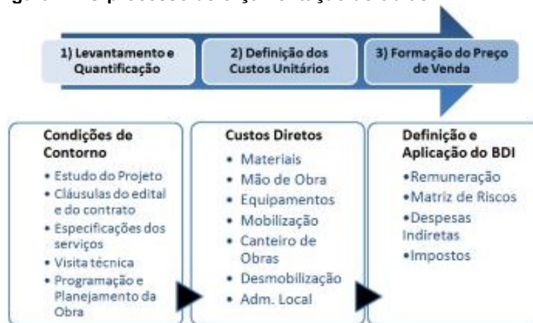
Figura 1 – O processo de orçamentação de obras
