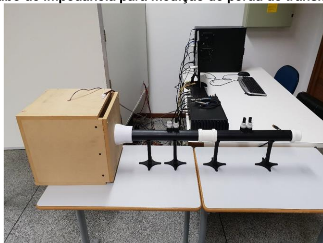
Figura 9 – Tubo de impedância para medição de perda de transmissão sonora
