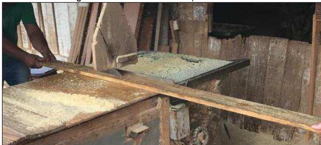
Figura 7 - Corte de madeira feito pela serra circular
