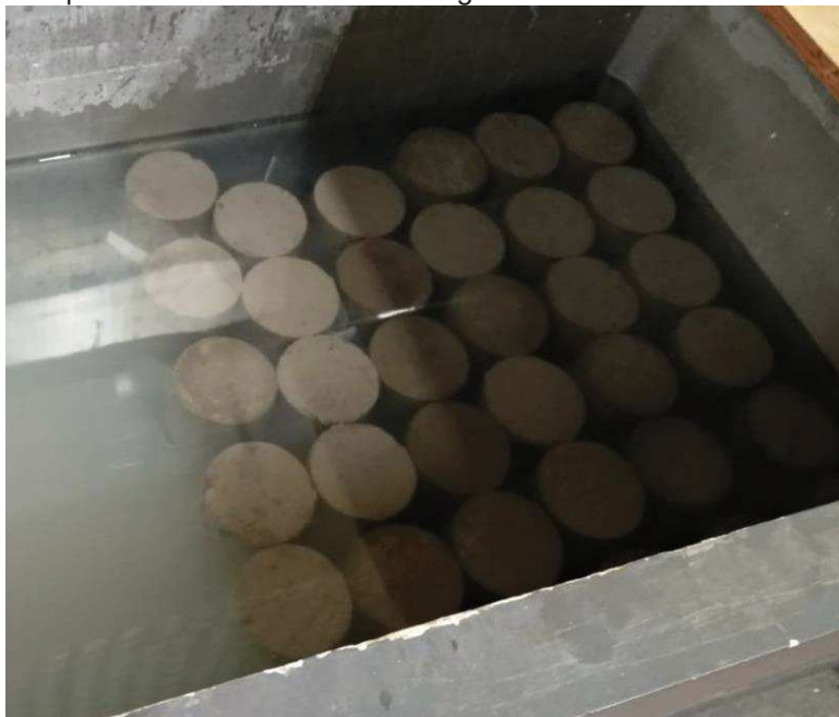
Figura 16 – Corpos de prova submetidos à cura em água saturada com cal
