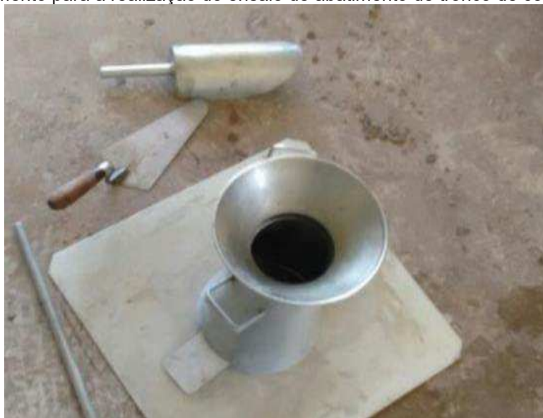
Figura 1 - Equipamento para a realização do ensaio de abatimento de tronco de cone (SLUMP test)
