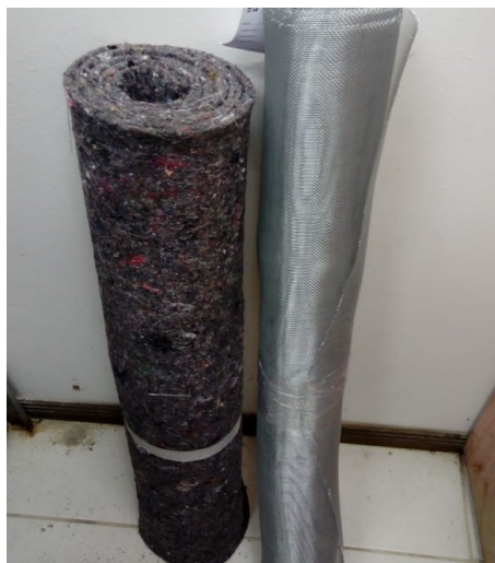
Figura 9 - Malha metálica: Aço Inox e feltro geotêxtil
