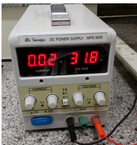
Figura 11 - Fonte de corrente contínua
