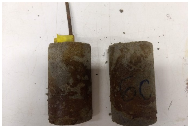
Figura 32 - Corpo de prova 6C 7D após realcalinização (1,5 A/m 2 )
