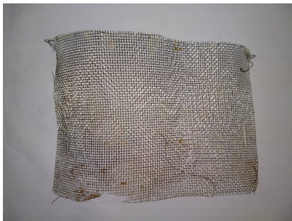
Figura 33 - Malha de aço após 7 dias com aplicação de corrente de 0,5 A/m 2
