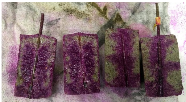
Figura 23 - Verificação da eficácia do método com uso de fenolftaleína em grupo “7D B”
