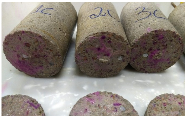
Figura 22 - Corpos de prova "C" fatiados com aspersão de fenolftaleína
