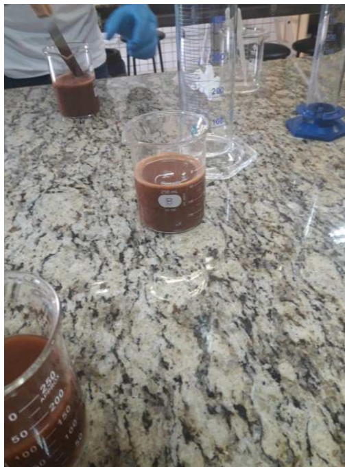
Figura 15 – Ação do defloculante em amostra de solo.
