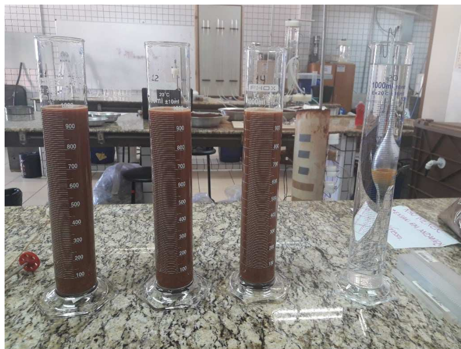
Figura 16 – Provetas preenchidas com material para sedimentação.
