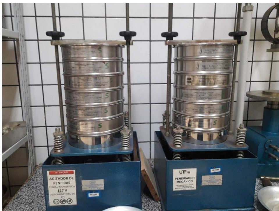
Figura 17 – Amostra de solo em agitador mecânico.
