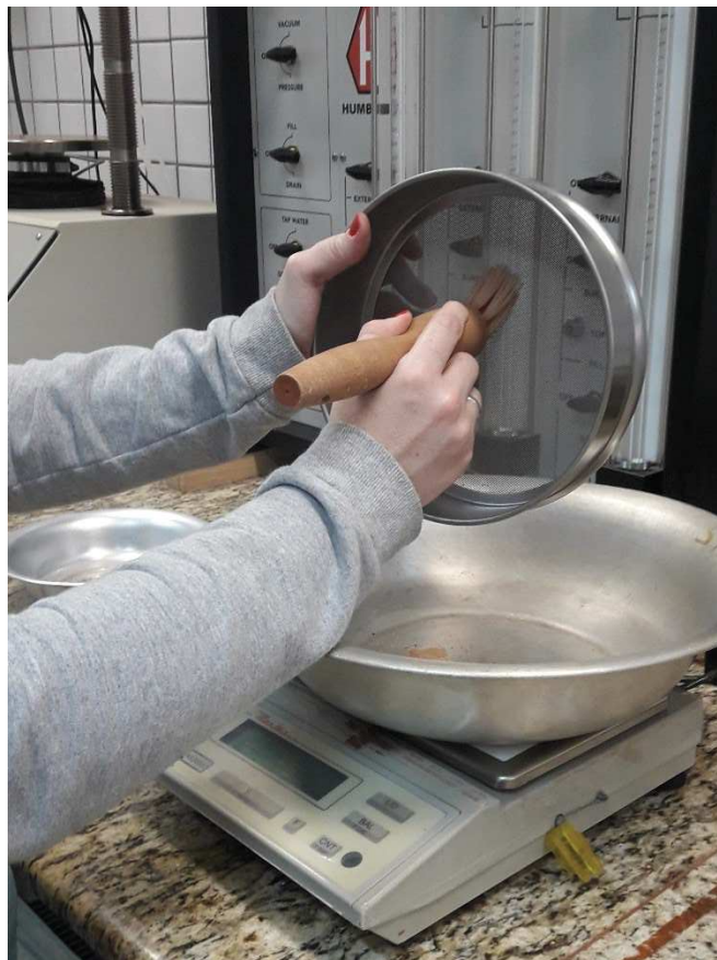
Figura 18 – Pesagem de material retido em peneira.
