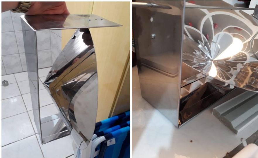
Figura 7 – Base cônica sendo fixada em um suporte
