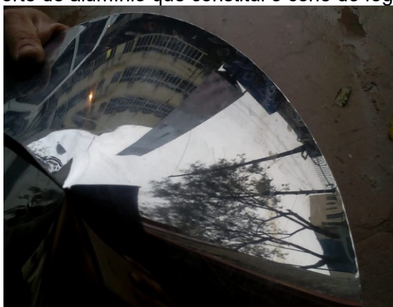
Figura 2 – Recorte de alumínio que constitui o cone do fogão solar.
