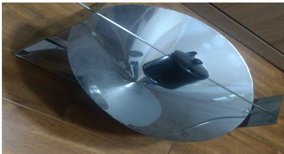
Figura 28 - Montagem final do fogão.
