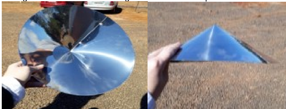
Figura 3 – Base cônica do fogão solar montada e parafusada
