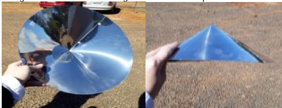
Figure 22 - Base cônica do fogão solar montada e parafusada.
