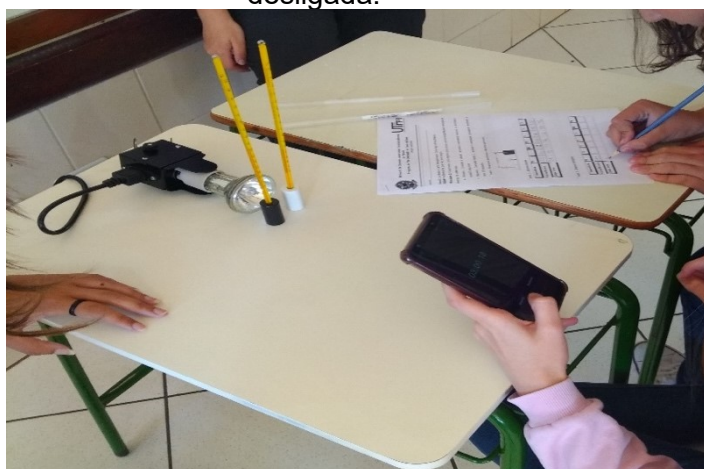
Figura 32 - Completando tabela de temperatura do corpo branco e preto, com a lâmpada desligada.
