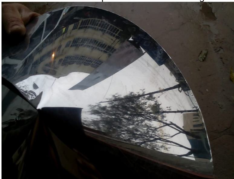
Figura 21 - Recorte de alumínio que constitui o cone do fogão solar.
