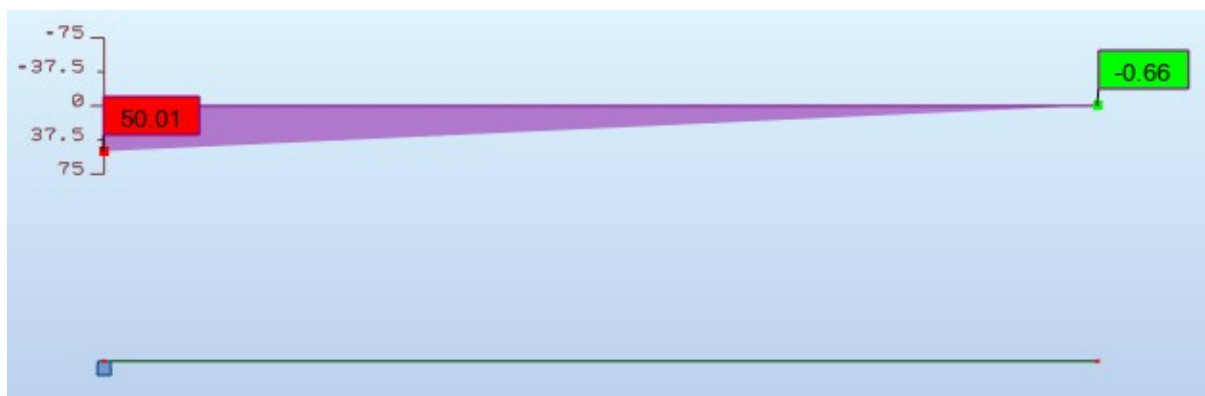
Figura 62 – Diagrama de momento fletor em torno do eixo y para o pilar P9.
