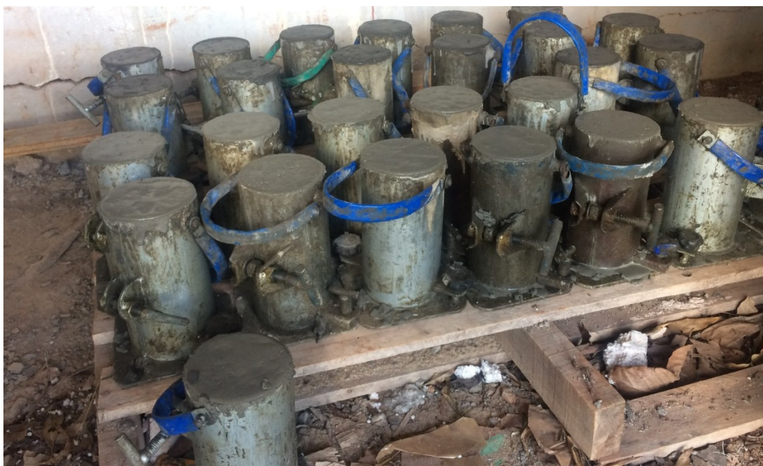
Figura 7 – Moldagem dos corpos de prova
