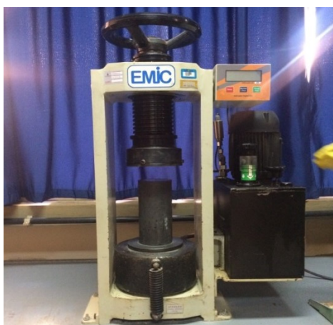
Figura 11 - Submissão dos corpos de prova ao ensaio de compressão
