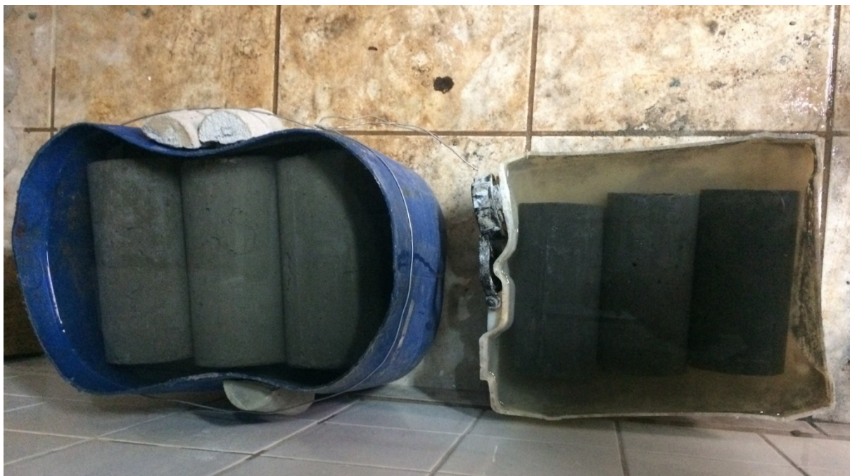
Figura 10 - Corpos de prova em exposição à solução de sulfato
