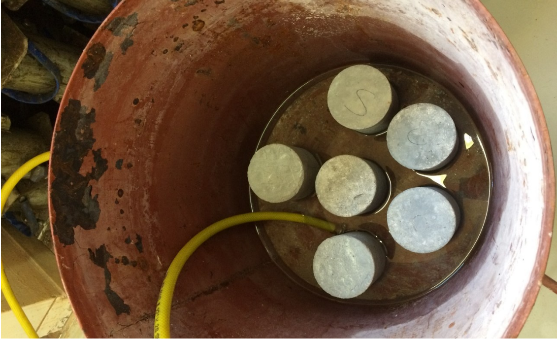
Figura 9 - Ensaio de Absorção de água por Imersão
