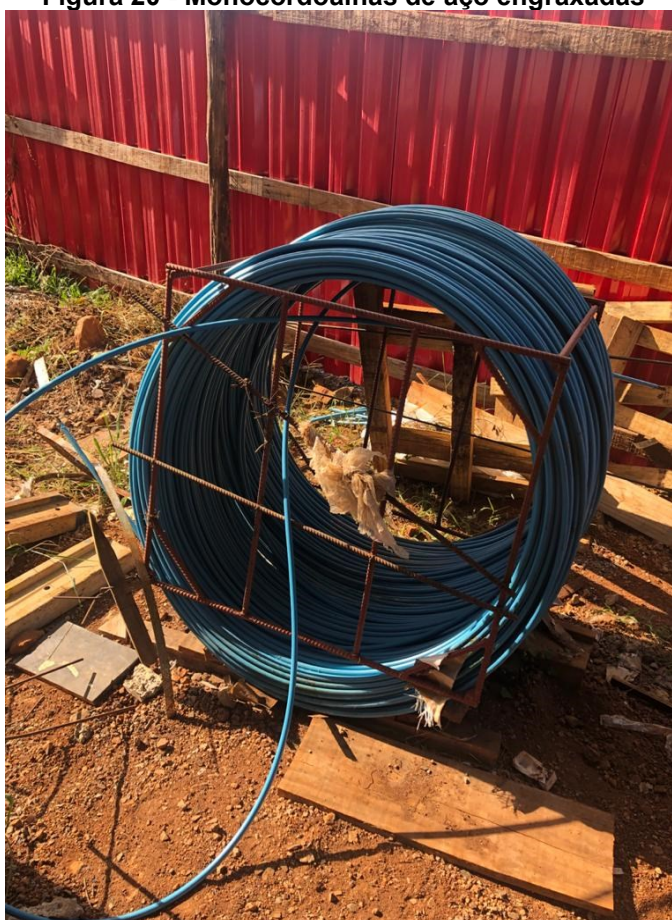
Figura 20 - Monocordoalhas de aço engraxadas
