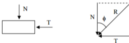
Figura 13 – Forças normal e tangencial, a força resultante entre a normal e tangencial, e o ângulo de atrito formado
