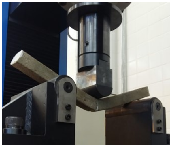
Figura 19 - Amostra rompida ensaio flexão 3 pontos
