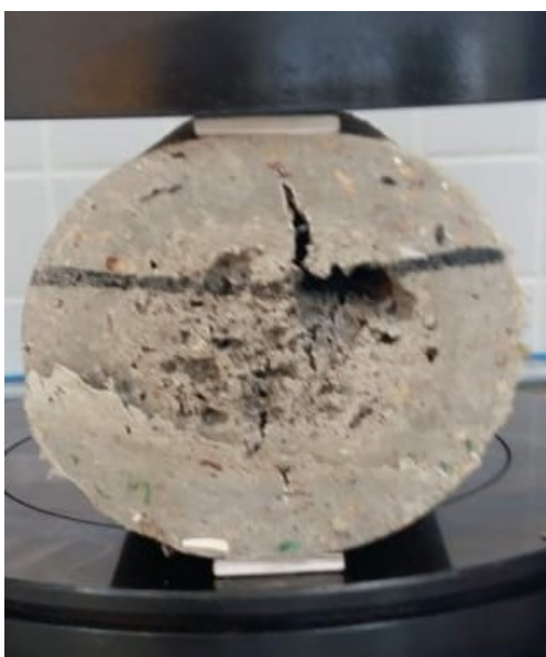
Figura 22 - Amostra rompida ensaio tração indireta
