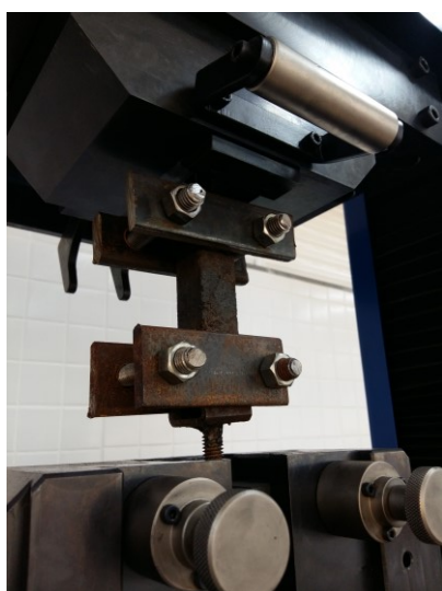
Figura 11 - Maquinário ensaio Tração Direta
