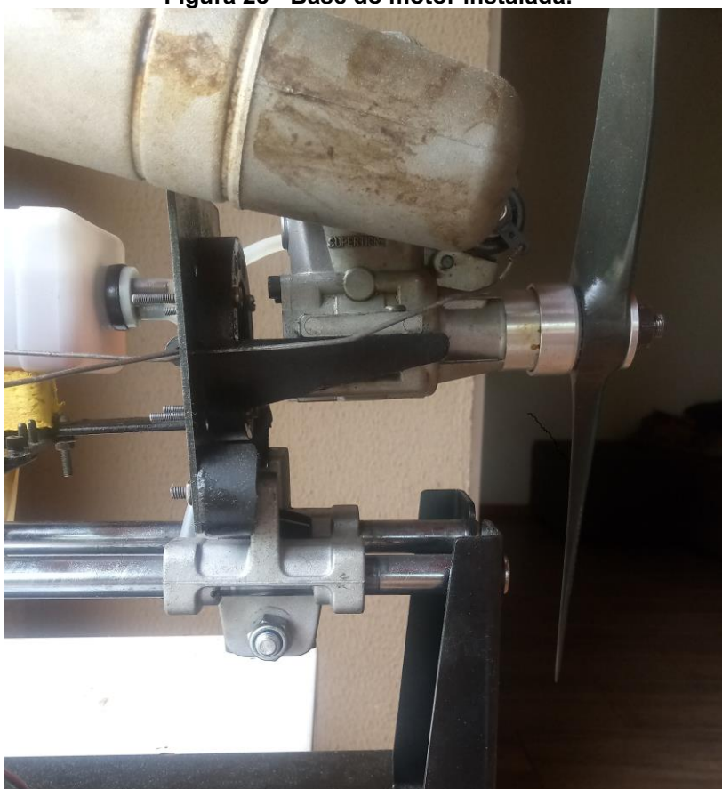
Figura 23 - Base do motor instalada.
