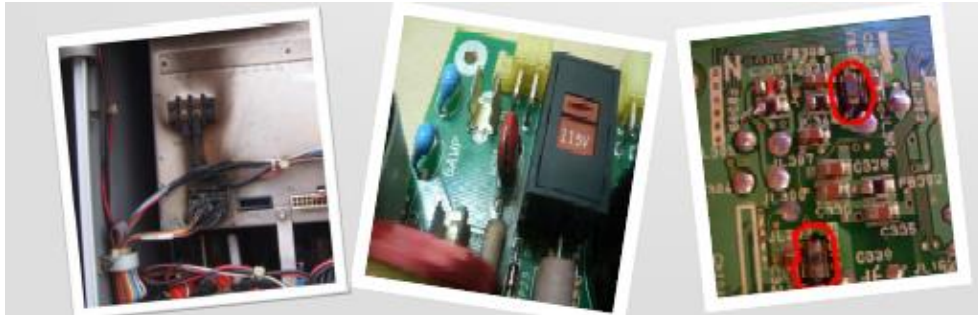
Figura 9: Exemplos de placas queimadas por surtos
