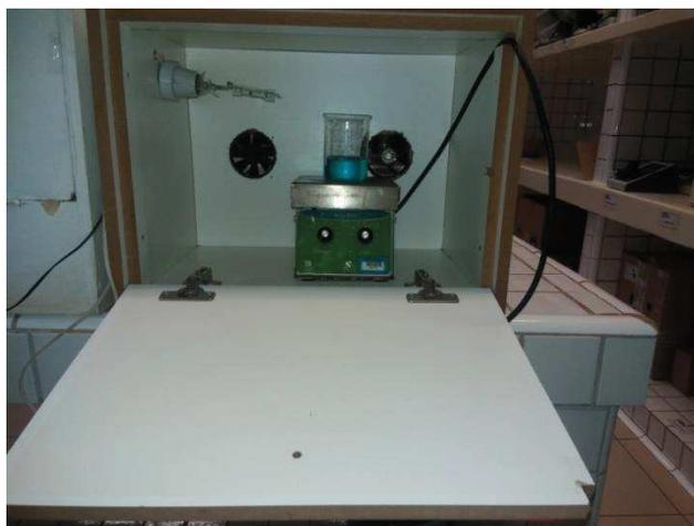
**Figura 3: Foto-reator utilizado nos testes de degradação do azul de metileno**
