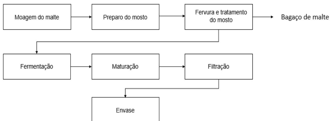
Figura 1 - Fluxograma com as principais fases do processo de obtenção de cerveja
