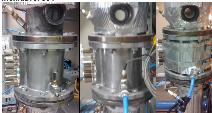
Fotografia 3 – Trocador de calor encamisado em aço inoxidável 304
