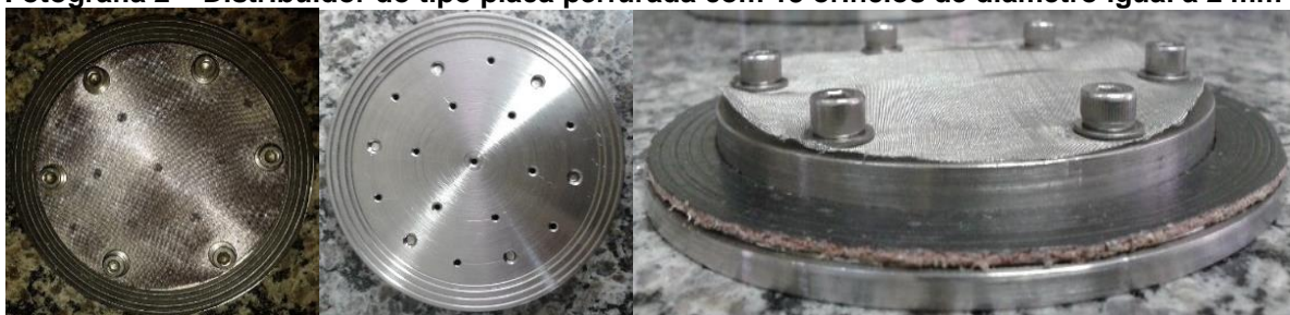
Fotografia 2 – Distribuidor do tipo placa perfurada com 13 orifícios de diâmetro igual a 2 mm
