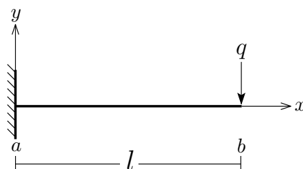
Figura 8 – Viga engastada a esquerda livre a direita, com carga concentrada
