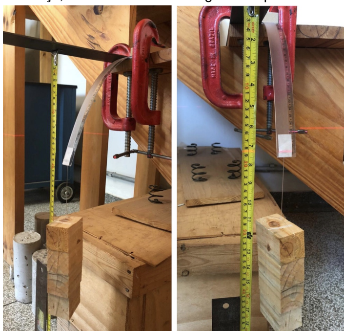
Figura 9 – Viga em balanço, submetida a um carregamento pontual em sua extremidade
