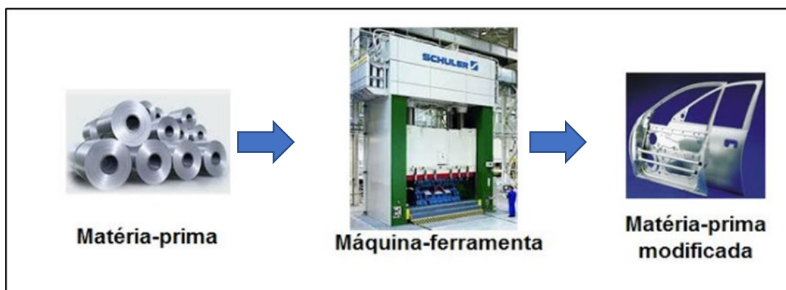
Figura 2.3 - Fluxograma do processo de estampagem.
