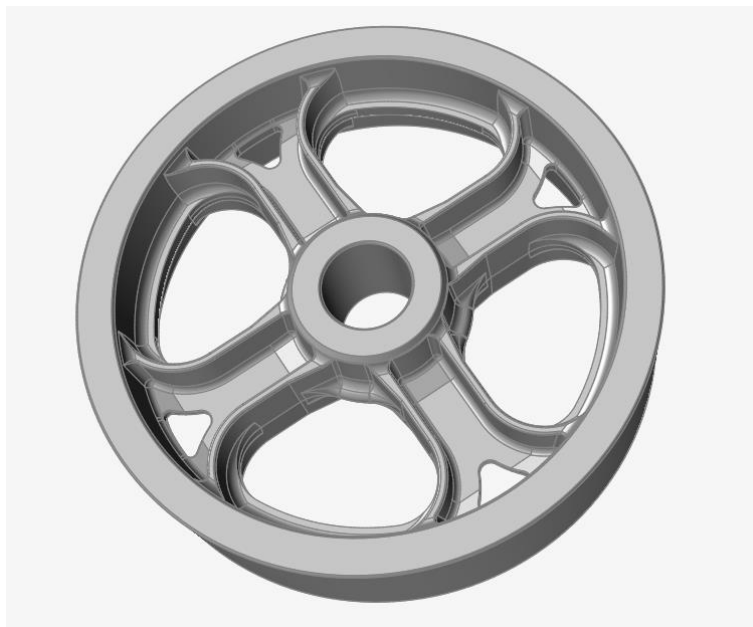
Figura 17 - Desenho tridimensional da peça em análise com dimensões brutas de fundição.
