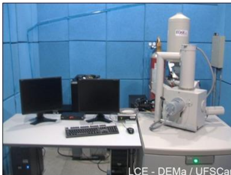
Figura 15 - Equipamento de MEV com filamento de tungstênio.
