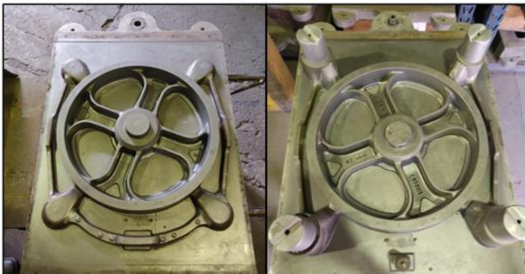
Figura 11 - Modelos utilizados na moldagem do molde de areia da polia.
