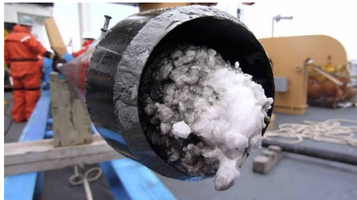
Figura 1.2 – Ilustração de um plug de hidrato em uma tubulação
