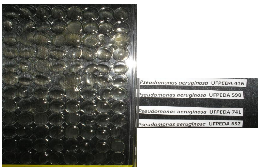
Figura 10 – Redução da tensão superficial por biosurfactante produzido por cepas de Pseudomonas aeruginosa (UFPEDA), pelo método da gota, em óleo de motor 40
