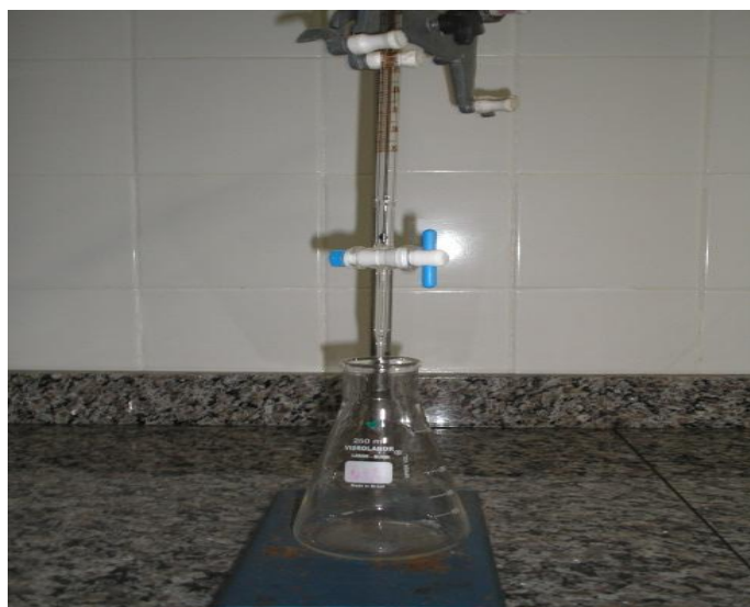
Figura 8 - Determinação da tensão superficial do biosurfactante pelo método do peso da gota
