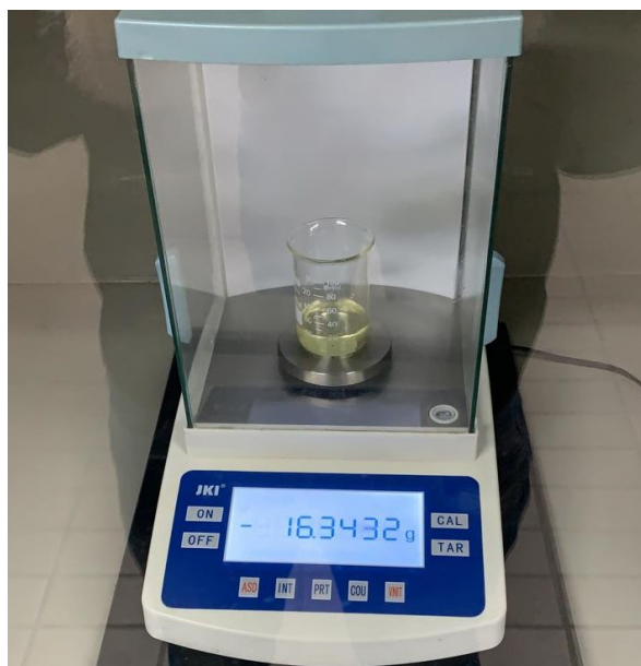
Figura 3-5: Medição da massa de óleo inserida no interior da célula utilizando uma balança analítica.
