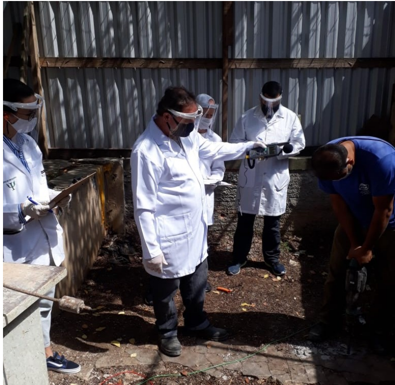
Figura 16 - Coleta de ruídos no martelete
