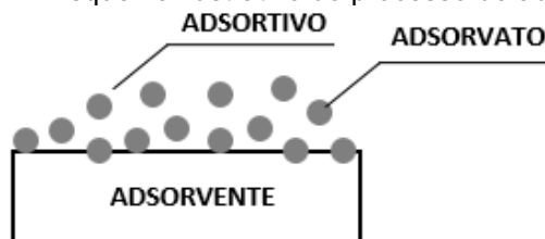
Figura 1 - Esquema ilustrativo do processo de adsorção
