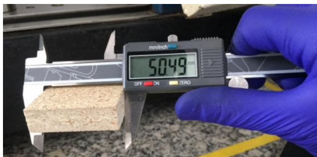
Figura 21 - Medição da largura para cálculo da densidade.
