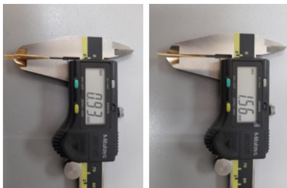
Figura 16 - Medição da espessura da partícula.
