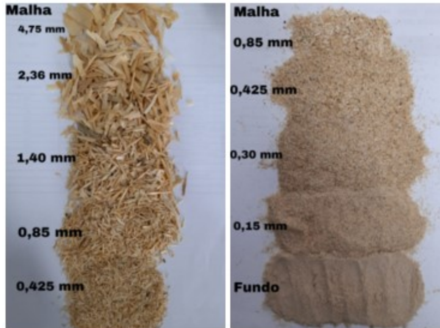
Figura 27 - Partículas classificadas após teste de granulometria.
