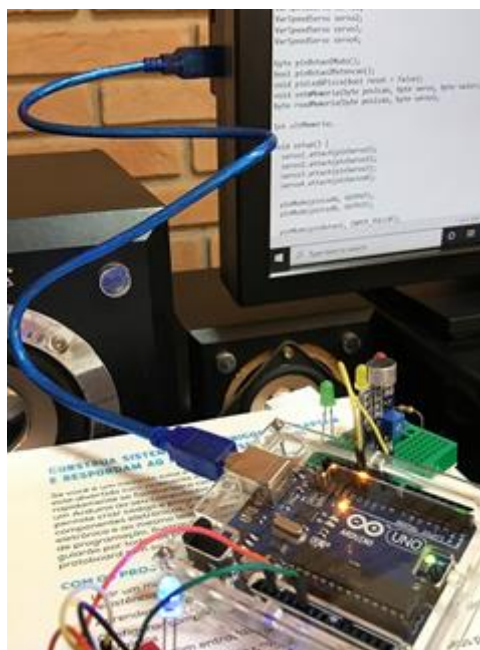
Figura 12 – Conexão do Arduino com a porta serial do PC.
