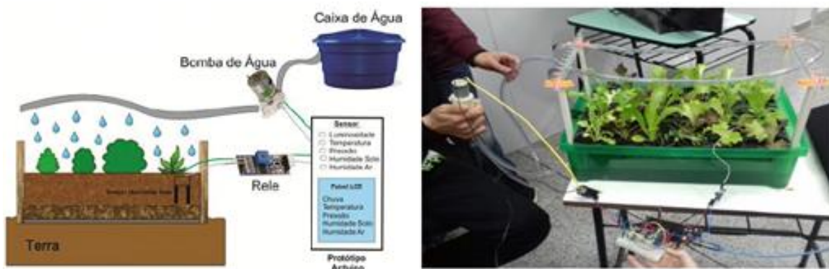
Figura 17 – Esquema da irrigação (à esq.) e aplicação prática (à dir.).
