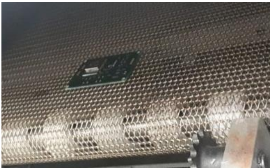
Figura 27. Entrada da placa no forno de refusão.
