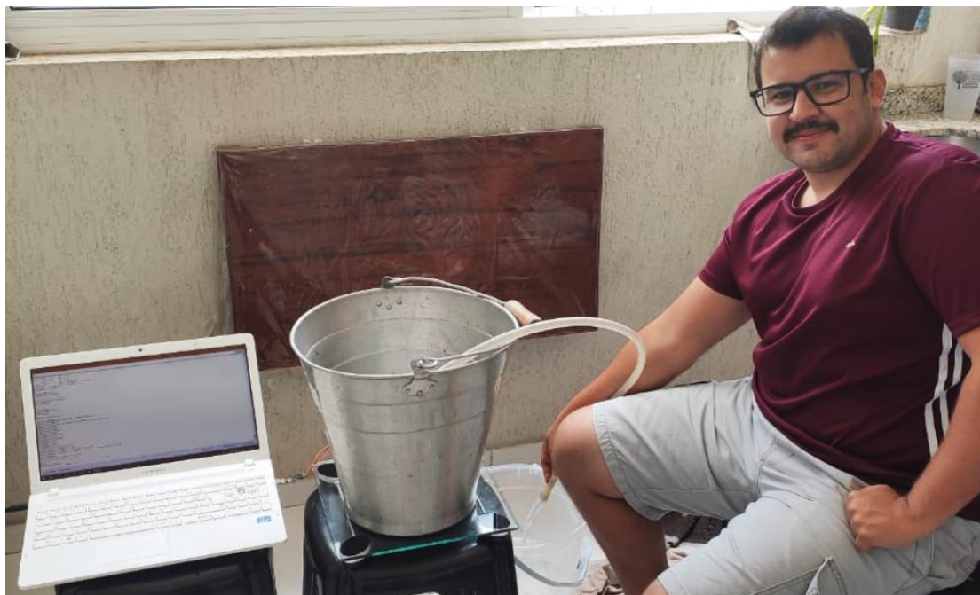
Figura 46. Teste da balança AWA com pesagens a partir de 13kg.
