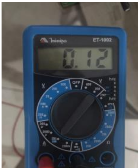
Figura 19. Medição do multímetro da corrente de entrada.
