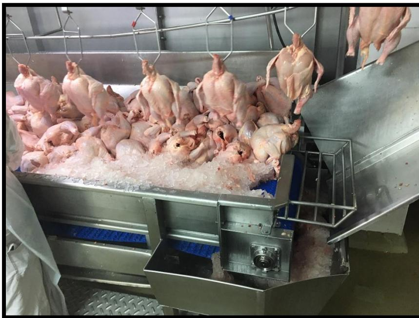
Figura 10: Perda de gelo através da saída do tanque para a esteira.
