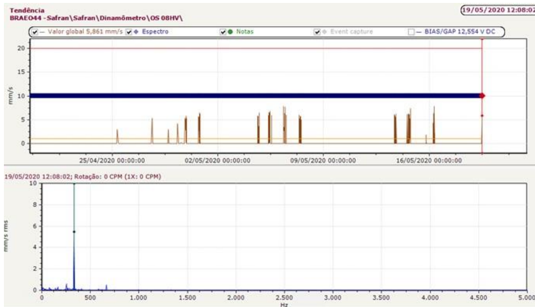
Figura 18: Parâmetro Velocidade do ponto 08 – Temos acima a tendência onde se observa a oscilação da vibração e abaixo o espectro com frequência predominante (01 x RPM).
