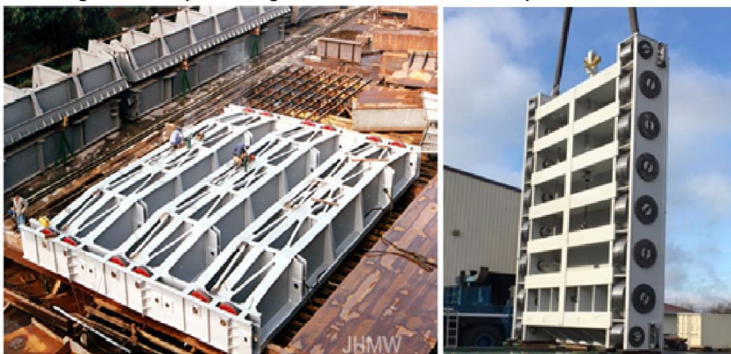
Figura 9: Comportas Vagão com eixos das rodas bi apoiados.
