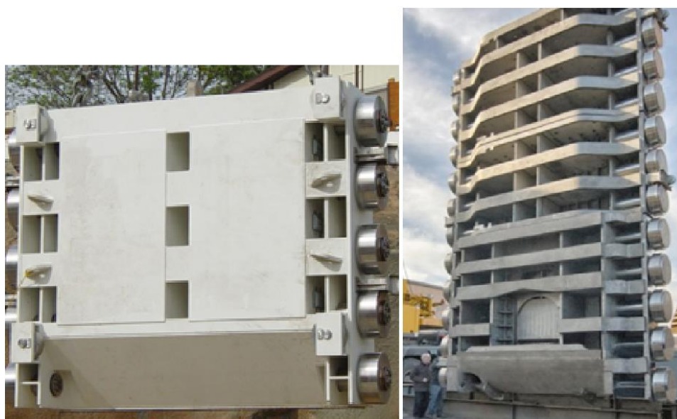
Figura 10: Comportas Vagão com eixos das rodas em balanço
