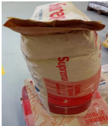
Figura 3: Identificação do problema – Embalagem com defeito na selagem
