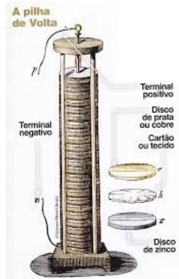
Figura 2 – Bateria de Volta.
