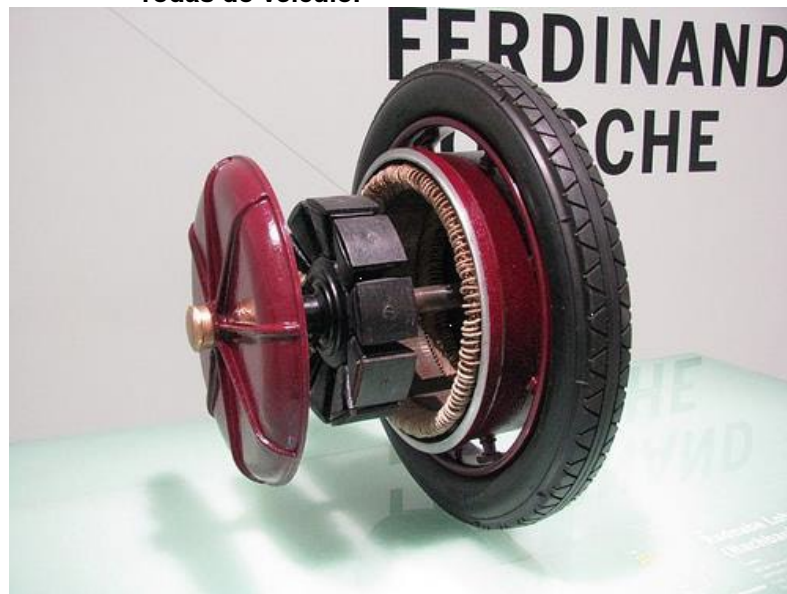
Figura 4 – Sistema de motorização elétrica diretamente nas rodas do veículo.
