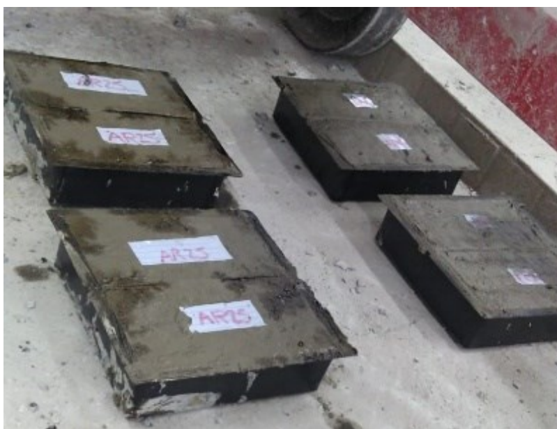
Figura 19 – Blocos de concreto moldados
