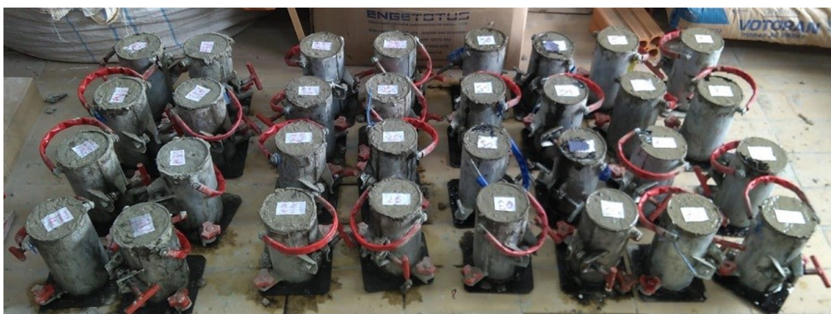
Figura 18 – Confeção dos corpos de prova cilíndricos
