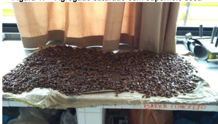
Figura 17 – Agregado saturado com superfície seca
