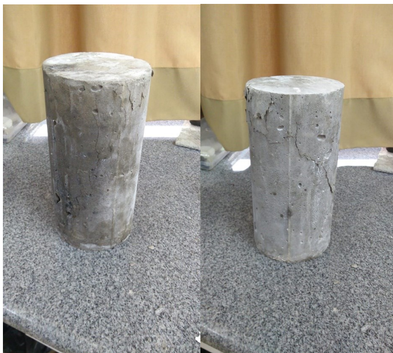
Figura 30 - CPs AR75 –Ruptura Tipo E – Cisalhada
