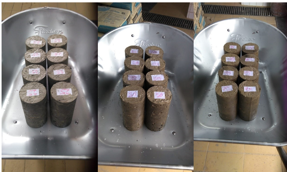
Figura 24 – Corpos de prova com Agregado Reciclado: AR25 (esq.); AR50 (meio); AR75 (dir.)
