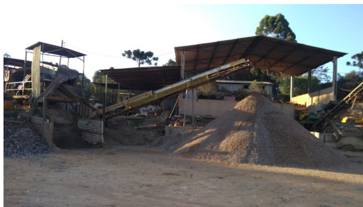
Figura 8 – Despejo do material peneirado
