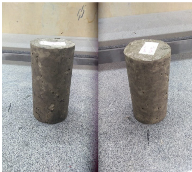
Figura 23 – Avaliação visual dos corpos de prova produzidos: Ref. (esquerda); AR25 (direita)
