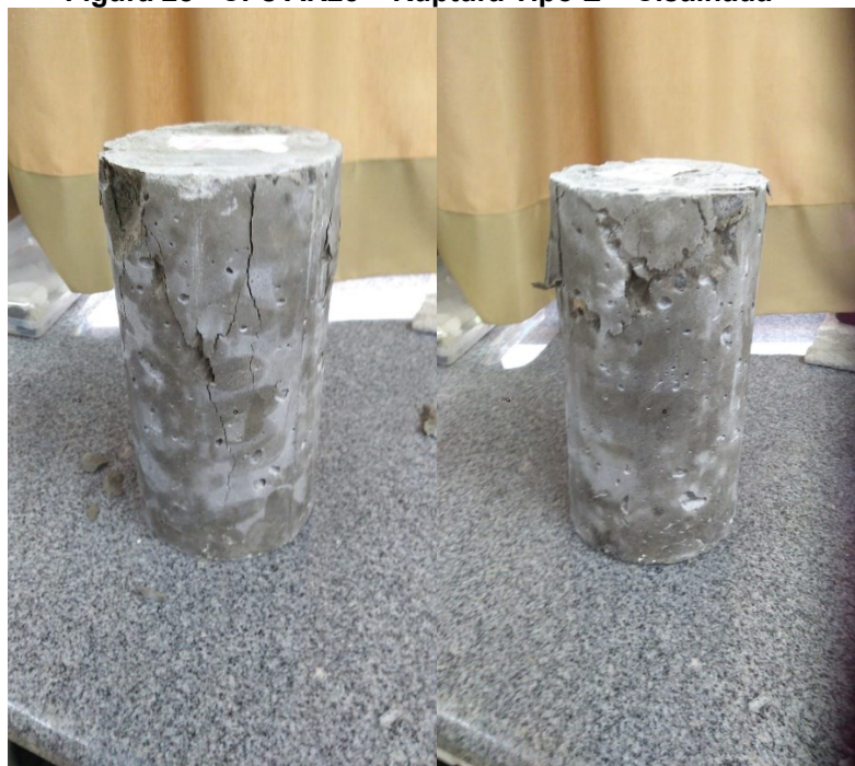
Figura 28 - CPs AR25 – Ruptura Tipo E – Cisalhada
