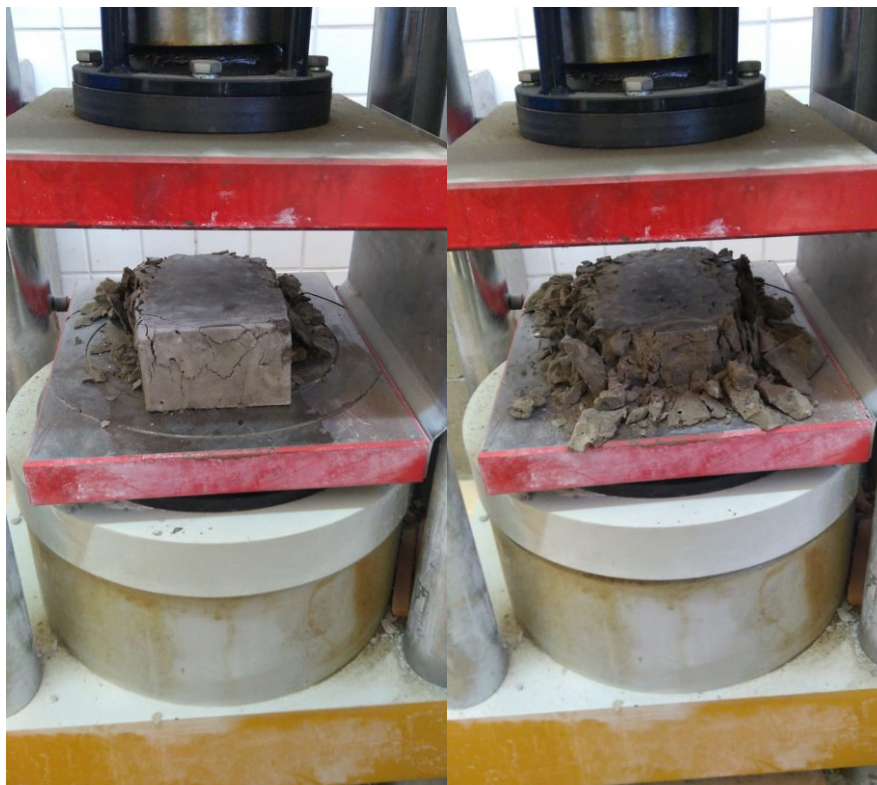
Figura 33 – Rompimento por esmagamento dos pavers
