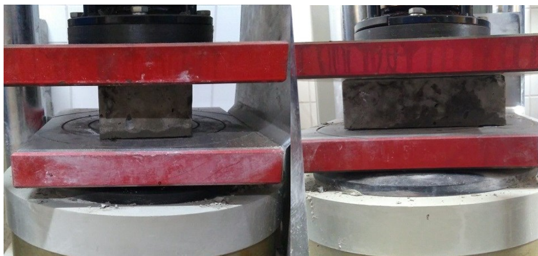
Figura 31 – Posicionamento dos pisos intertravados na prensa
