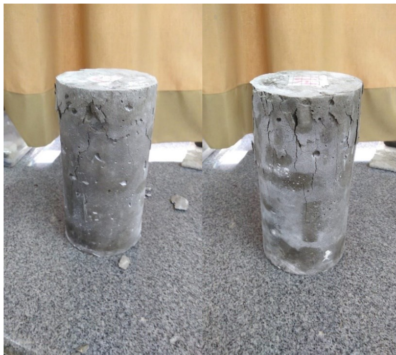
Figura 27 – CPs de referência – Ruptura Tipo B – Cônica com mais de uma partição
