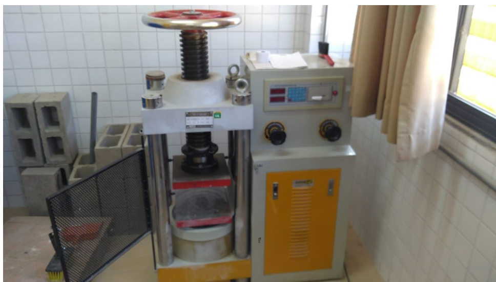
Figura 21 – Prensa usada nos ensaios à compressão
