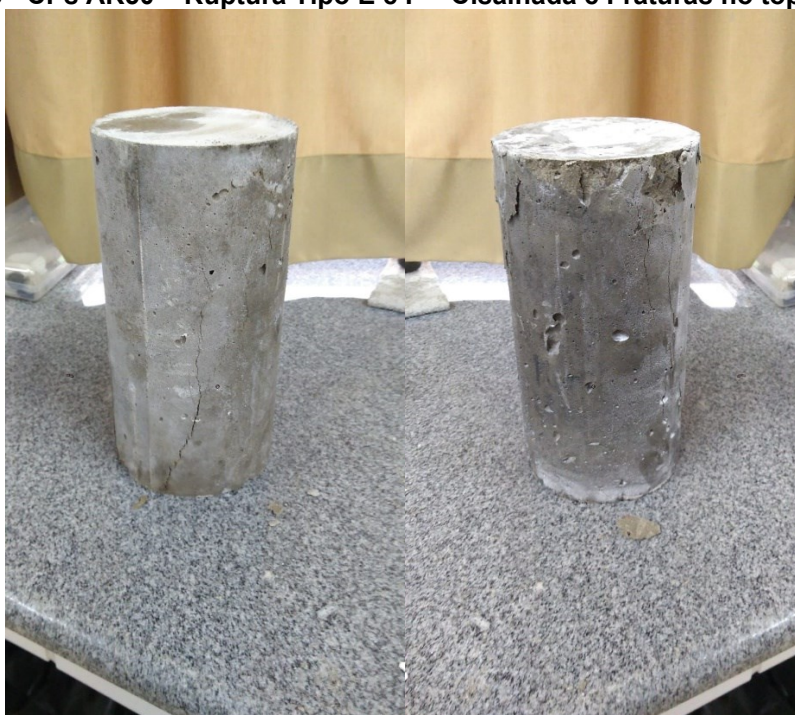
Figura 29 - CPs AR50 – Ruptura Tipo E e F – Cisalhada e Fraturas no topo ou base
