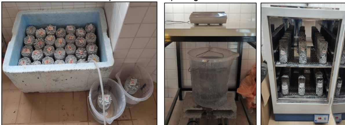
Figura 11 – Ensaio de absorção de água, índice de vazios e massa específica a) Saturação b) Massa imersa c) Secagem em estufa
