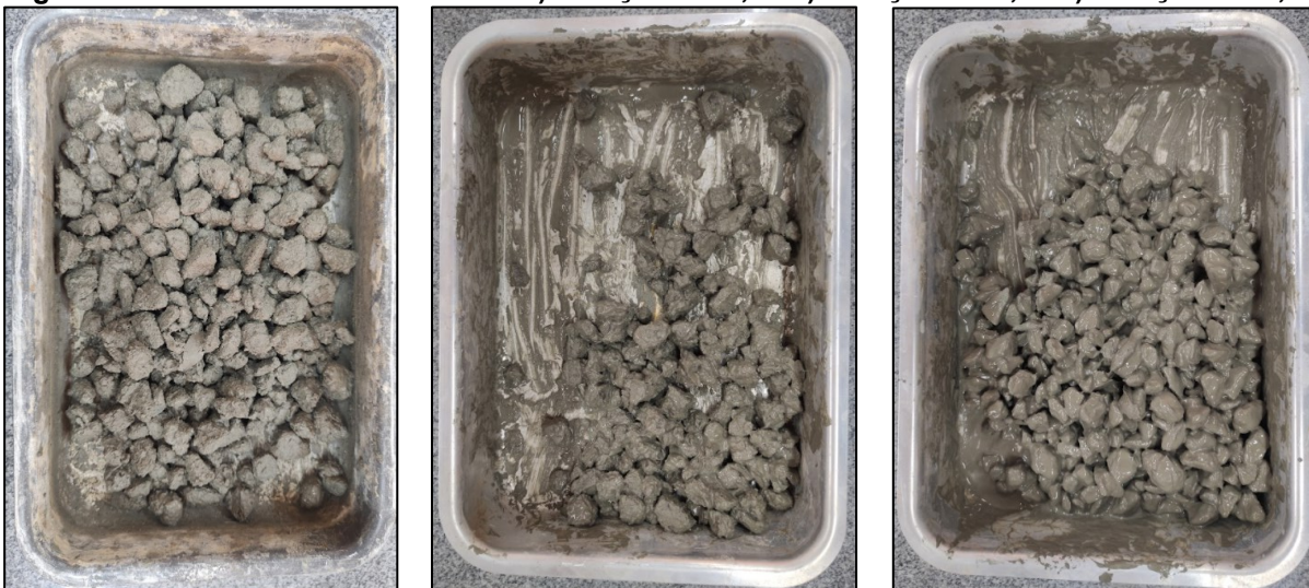
Figura 6 – Misturas no estado fresco a) Relação a/c 0,30 b) Relação a/c 0,35 c) Relação a/c 0,40
