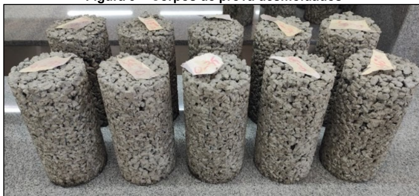
Figura 9 – Corpos de prova desmoldados
