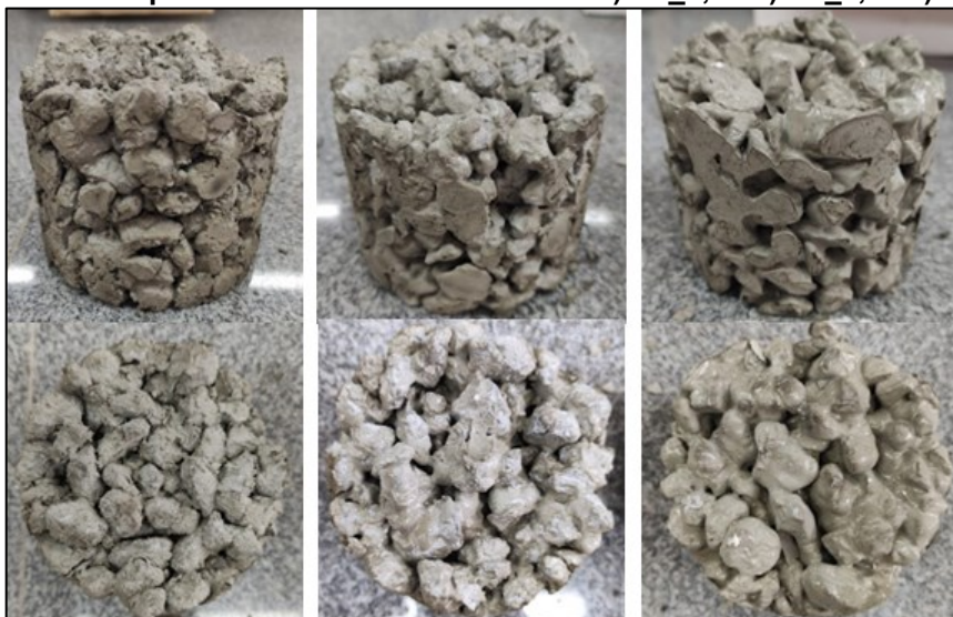
Figura 7 – Teste preliminar – estado endurecido a) B1_0,30 b) B1_0,35 c) B1_0,40
