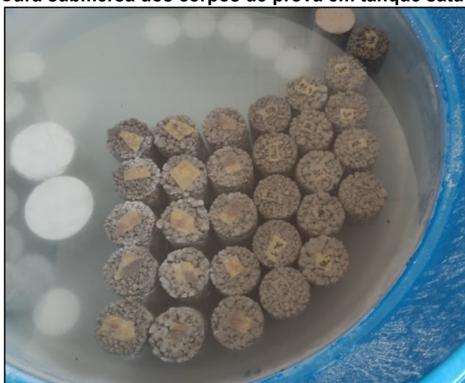
Figura 10 – Cura submersa dos corpos de prova em tanque saturado com cal
