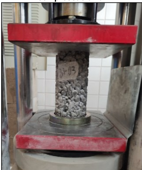
Figura 12 – Ensaio de resistência à compressão axial
