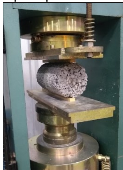
Figura 13 – Ensaio de resistência à tração por compressão diametral
