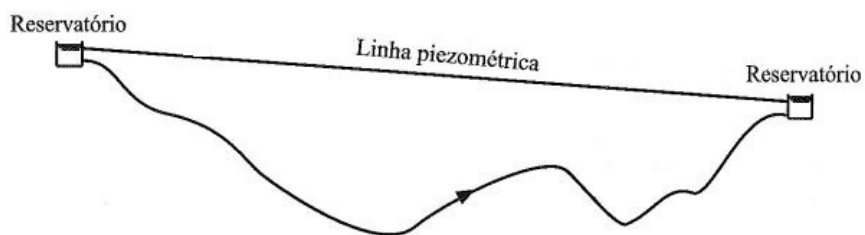
Figura 2 – Exemplo de adutora por gravidade
