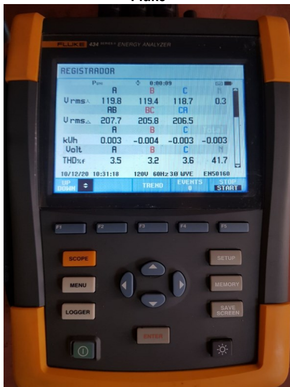
Figura 15 - Analisador de energia da marca Fluke
