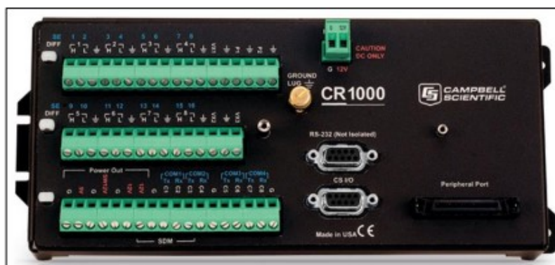
Figura 26 – Datalogger Utilizado em Sistemas de Automação de Barragens.
