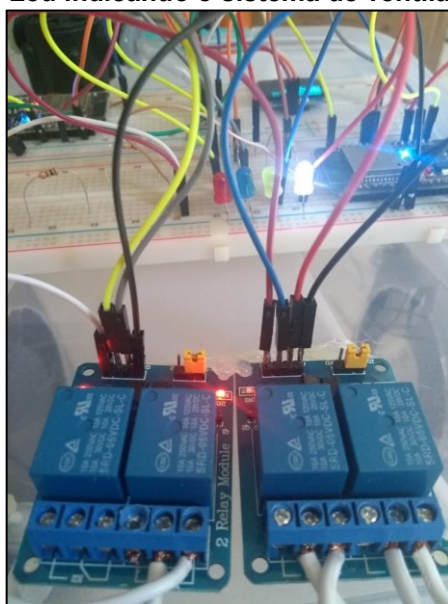
Figura 43: Led indicando o sistema de ventilação ligado.
