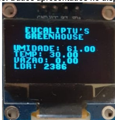
Figura 45: Dados apresentados no display LCD.
