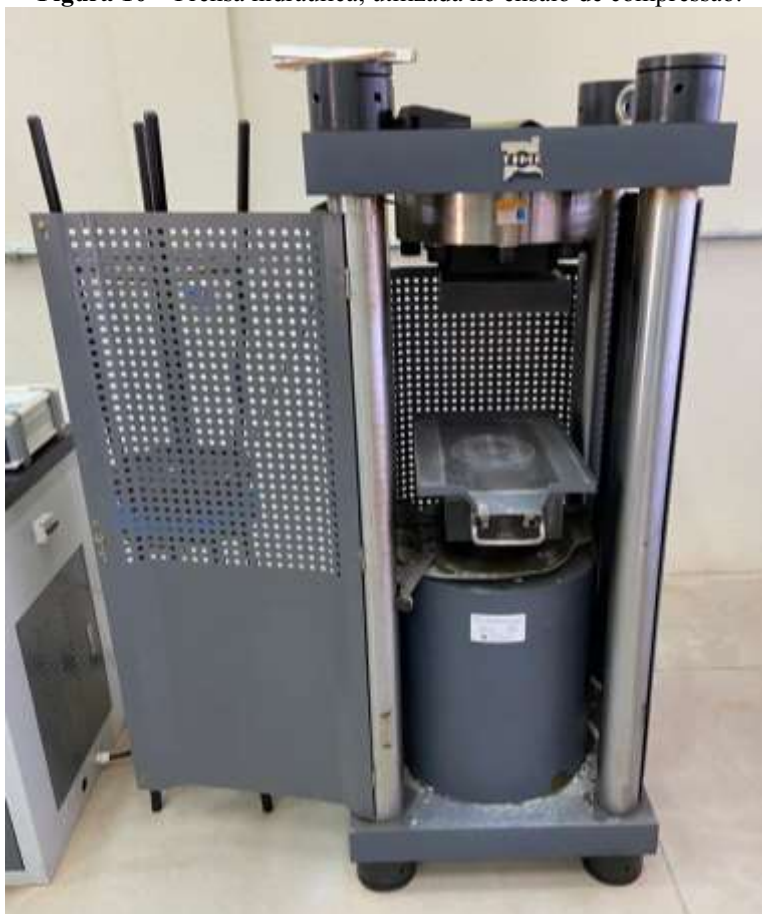
Figura 10 – Prensa hidráulica, utilizada no ensaio de compressão.
