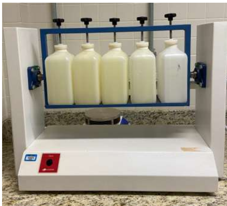
Figura 8 – Equipamento para teste de lixiviação.
