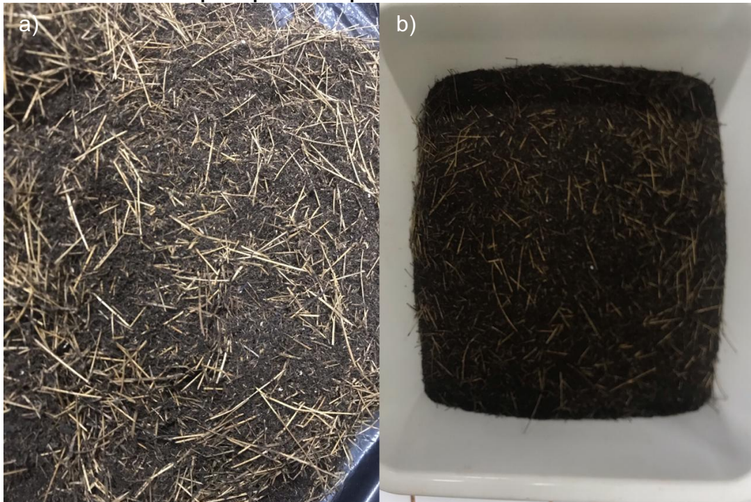
Figura 5 – a) Composto antes de passar pelo moinho de martelo; b) Composto após passar pelas peneiras e pelo moinho de martelo
