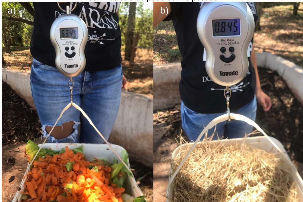
Figura 3 – a) Balde com resíduo orgânico sendo pesado com a balança digital de mão; b) Balde com resíduo de poda sendo pesado
