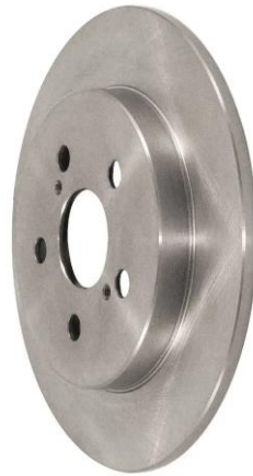
Figura 2.2 - Disco de freio sólido
