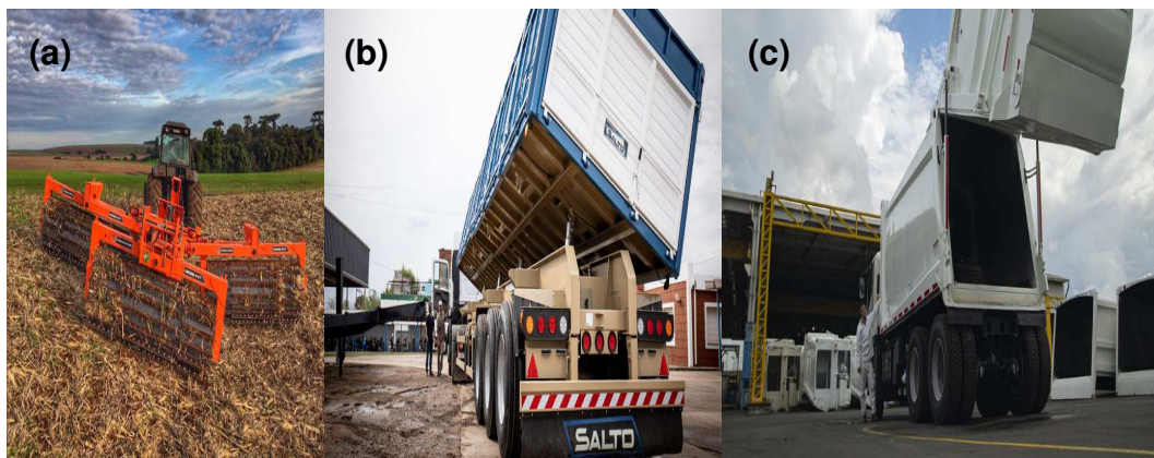
Figura 8 - Exemplos de aplicações de aços Hardox®: (a) rolo de facas Katrina, (b) carreta basculante e (c) carrocerias de caminhões de lixo.
