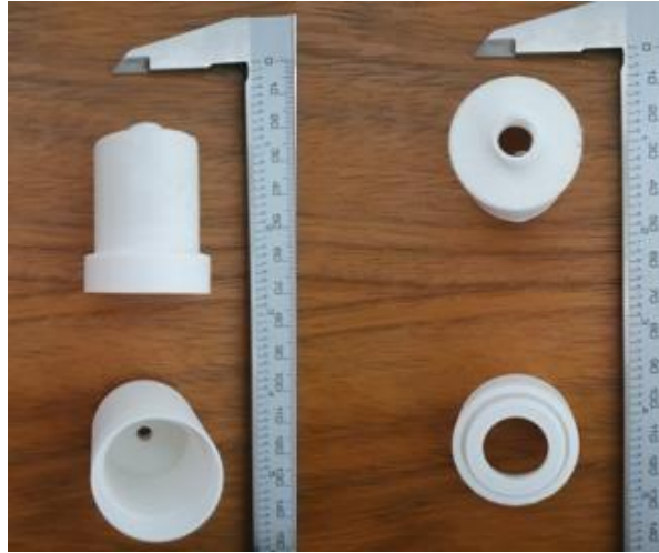
Figura 86 - Design impresso do suporte da válvula aorta em PLA branco.
