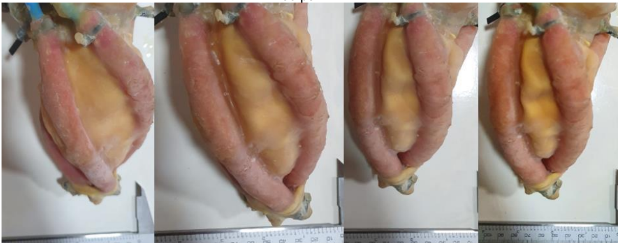
Figura 65 – Vista lateral da contração da parede ventricular com o sistema pneumático em 0, 60, 70 e 80 psi.
