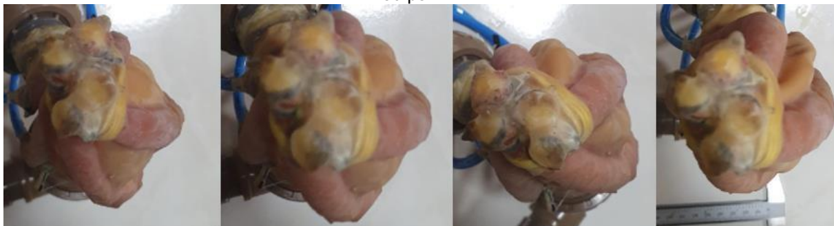
Figura 66 - Vista inferior da contração da parede ventricular com o sistema pneumático em 0, 60, 70 e 80 psi.
