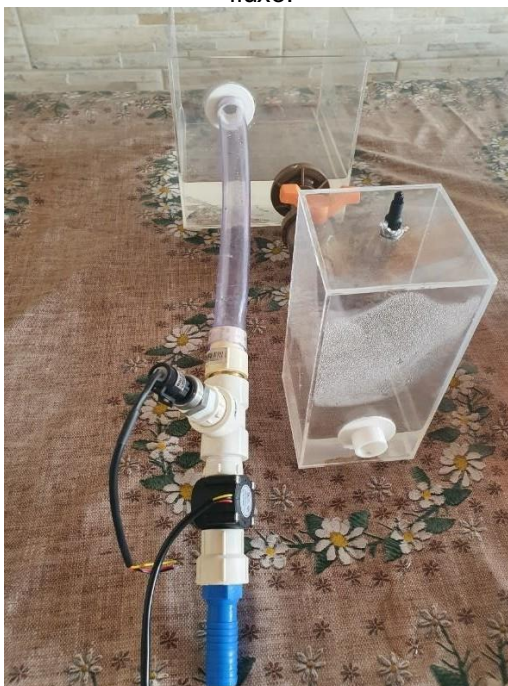
Figura 60 - MCL utilizado com o reservatório, simulação da complacência, sensores de pressão e fluxo.
