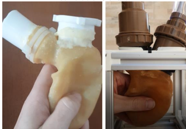
Figura 53 - VE em látex com as válvulas projetadas a esquerda, e com válvulas de retenção comerciais na direita.
