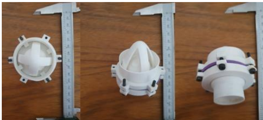
Figura 88 - Design impresso do suporte da válvula mitral em PLA branco.
