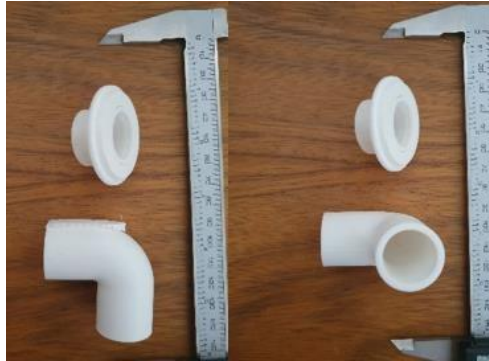
Figura 58 - Conectores utilizados no MCL impressos em PLA branco.
