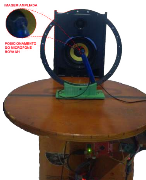
Figura 30 – Posicionamento dos equipamentos durante as medições do microfone BOYA M1
