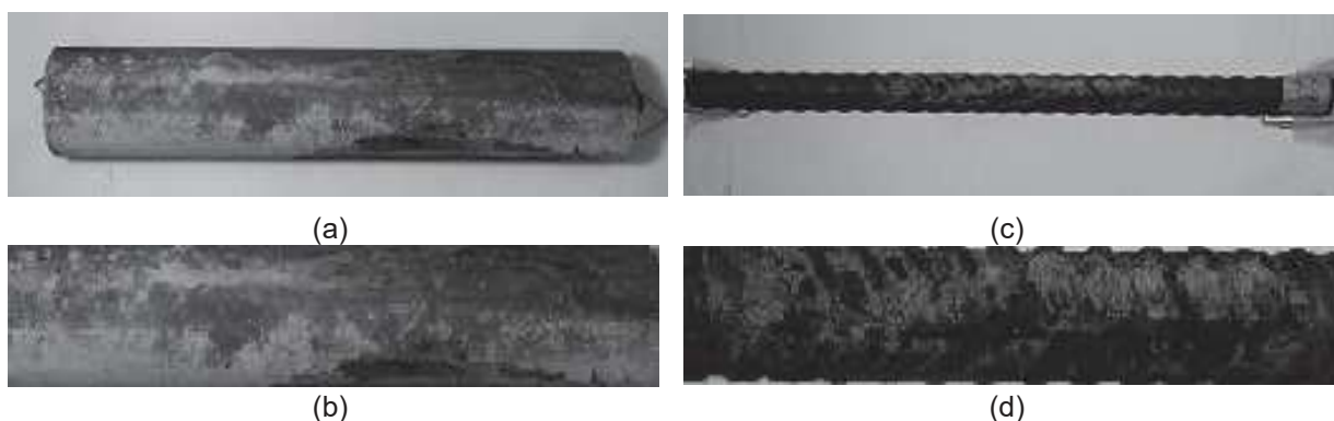
Figura 3.6: Segmentação das imagens com corrosão: (a) Corpo de concreto com fundo cinza e sombras; (b) Corpo de concreto segmentado; (c) Barra de aço com fundo cinza e sombras; (d) Barra de aço segmentado. Fonte: Autoria Própria (2021)
