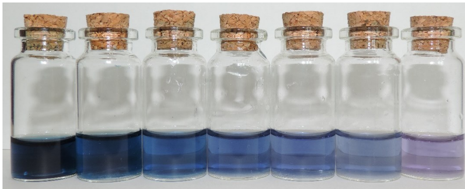
Figura 23 - Amostras dos ensaios experimentais de fotocatalise para degradação do corante azul reativo 5G utilizando reator fotocatalítico solar construído.
