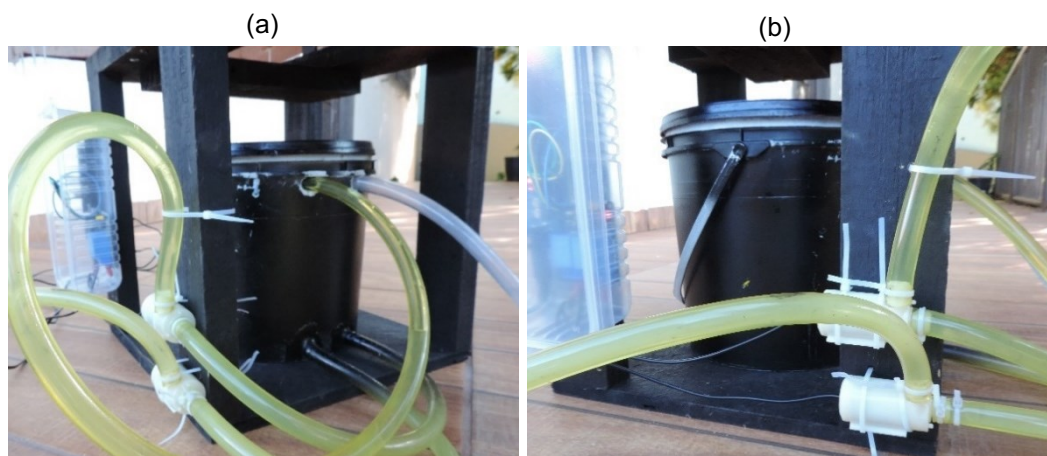
Figura 20 - Disposição das bombas de recirculação do reator fotocatalítico solar.
