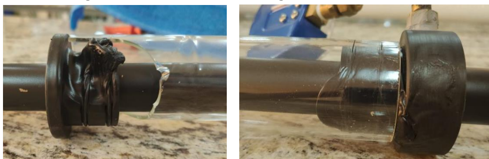
Figura 23 – Problemas de montagem do tubo evacuado.
