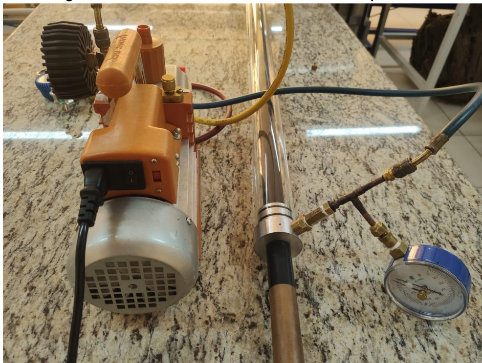
Figura 21 – Montagem do tubo evacuado com bomba de vácuo acoplada à válvula de serviço.
