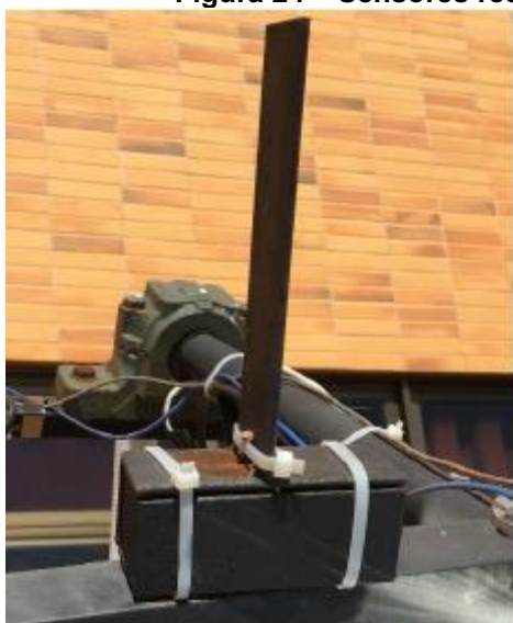
Figura 24 – Sensores responsáveis pelo rastreamento solar.
