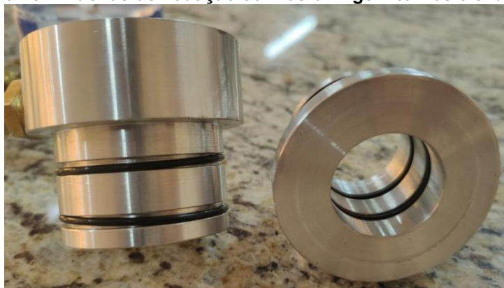
Figura 19 – Buchas de vedação com os o-rings internos e externos.
