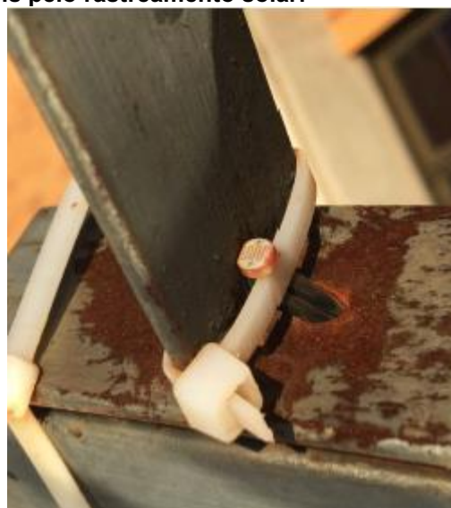
Figura 24 – Sensores responsáveis pelo rastreamento solar.
