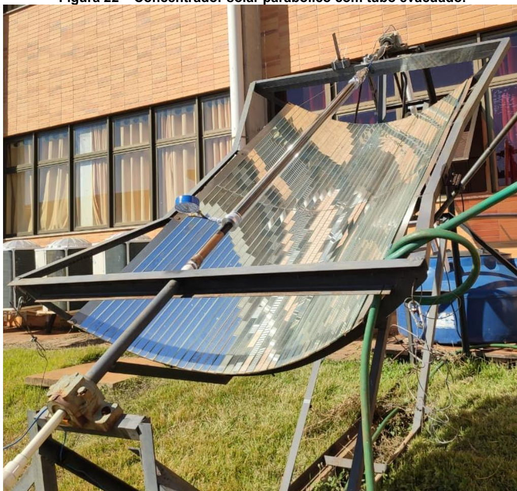
Figura 22 – Concentrador solar parabólico com tubo evacuado.
