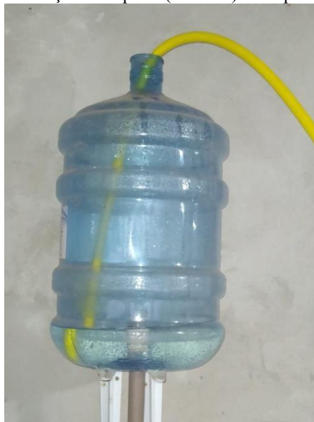
Figura 8 – Alimentação de líquido (efluente) a temperatura ambiente.
