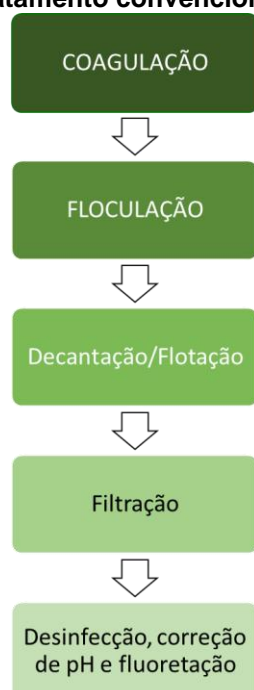
Figura 2 – Esquema das etapas de tratamento convencional de água.
