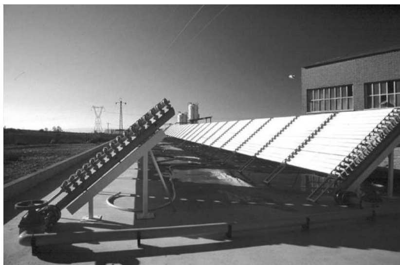
Figura 3 - Visão parcial da planta de demonstração da Plataforma Solar de Almería, mostrando reator do tipo CPC, adotado para os experimentos solares realizados na instituição.
